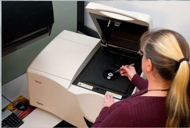
Рис. 20. На снимках – работы ведутся на приборах по изучению спектроскопии в видимом и инфракрасном диапазоне и их отражательной способности. С помощью современного оборудования возможно более детальное исследование оптических свойств минералов. Лаборатория Геммологического института Америки [GIA].
