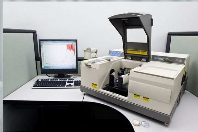
Рис. 19. На снимках – работы ведутся на приборах по изучению спектроскопических особенностей драгоценных камней в видимом и инфракрасном диапазоне. С помощью современного оборудования возможно более детальное исследование структуры, оптических свойств минералов. Лаборатория Геммологического института Америки [GIA].
