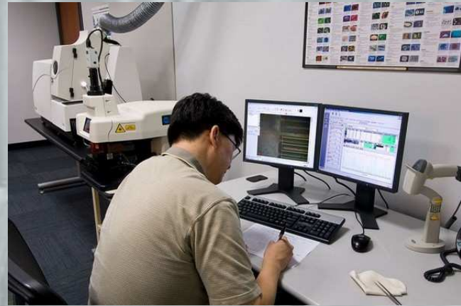
Рис. 20. На снимках – работы ведутся на приборах по изучению спектроскопии в видимом и инфракрасном диапазоне и их отражательной способности. С помощью современного оборудования возможно более детальное исследование оптических свойств минералов. Лаборатория Геммологического института Америки [GIA].
